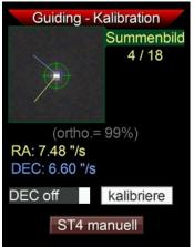
Cursor auf "kalibriere" setzen und mit SET Kalibration starten. Der Vorgang läuft automatisch ab und endet mit der Anzeige der Ergebnisse. Die Geschwindigkeit mit der sich der Multistern in RA und DEC bewegt wird angegeben, sowie die Orthogonalität der Bewegungsrichtungen.
