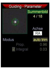
RA und DEC Achse werden getrennt angewählt, hier das normale Aussehen des **RA** Bildschirms. Als Modus ist **auto trim** ausgewählt, das bedeutet dass der Mgen-3 ständig selbsttätig die Werte optimiert um die Abweichungen zu minimieren. Die Funktion ist im Prinzip wie bei einem PI Regler, die Korrektur der gemessenen Abweichung wird durch einen längerfristig wirksamen Term ergänzt. Beide Werte werden laufend neu abgestimmt und passen sich so auch sich ändernden Verhältnissen an.
