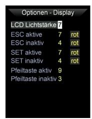
Einstellung der Leuchtstärken für Display und Tasten LEDs LCD: Die Hintergrundbeleuchtung des Displays ESC und SET: aktiv (Kamerasteuerung Signale) und inaktiv Pfeiltasten: aktiv (ST4 Signal Ausgabe) und inaktiv
