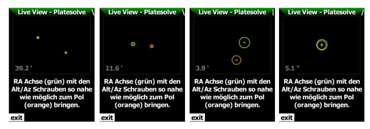
Wenn Sie die RA Achse in die Nähe des Pols bringen, wird die Ansicht automatisch eingezoomt und es erscheinen Kreise um die beiden Kreuze. Je kleiner der Abstand wird wird, desto geringer müssen die Korrekturen an den Alt/Az Schrauben sein. Eine Genauigkeit von weniger als 5arcmin ist für die Astrofotografie bei Verwendung eines Autoguiders völlig ausreichend, aber man kann ausprobieren, wie nah man herankommt. Mit **exit** beenden.
