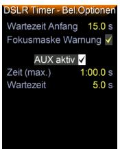
**Wartezeit Anfang** – nach dem Auslösen der Start Funktion verstreicht die hier eingegebene Wartezeit, bevor die erste Belichtung der Sequenz ausgelöst wird. Nützlich, wenn man zB auf einem instabilen Balkon fotografiert, und Zeit braucht um sich zu entfernen. Max. 25s.
