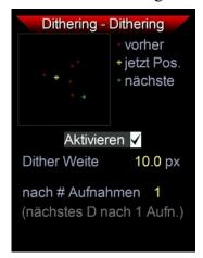
Es ist empfehlenswert, Dithern immer aktiviert zu haben. Die Dither Weite kann bis 99,9 Pixel erhöht werden. In der Praxis reichen Werte um 10-15 Pixel für den Effekt. Die Mgen-3 Kamera hat Pixelgrösse 3.75µm und z.B. mit einem Verhältnis von Aufnahme zu Guiding Brennweite von 5:1 wäre das ein Versatz von 50-75 Pixel auf einer Kamera mit derselben Pixelgrösse. Bei sehr kleinen Aufnahmebrennweiten kann man den Wert erhöhen, aber das Dithern dauert dann auch länger.
