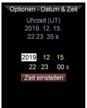
Der Mgen-3 verfügt über eine Echtzeituhr, welche auch nach dem Abschalten weiterläuft und durch eine innere Batterie (CR2032) versorgt wird. Sie befindet sich auf der Rückseite der Platine, welche zum Tausch herausgenommen werden kann.
