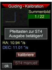
Unten am Bildschirm befindet sich die Schaltfläche "ST4 manuell", sie ermöglicht es die ST4 Impulse manuell auszugeben. Eine sehr wichtige Möglichkeit, bei Problemen die Verbindung zur Montierung zu kontrollieren. Cursor darauf setzen und per SET bestätigen, es erscheint ein Kästchen mit dem Hinweis, dass nun die ST4 Signale durch Drücken der Pfeiltasten gesendet werden können. Sie sehen im kleinen Bild wie der Multistern reagiert.
