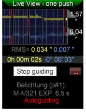
Der Status des Belichtungstimers wird praktischerweise auch auf dem **Onepush**-Bildschirm angezeigt. In der ersten Zeile sehen Sie das aktive Programm p#. Die Zeile darunter zeigt die Nummer der aktuellen Belichtung sowie die Gesamtzahl der Belichtungen, dann den Status (EXP = Belichtungszeit, W = Wartezeit, ML = Spiegelvorauslösung) und schließlich die laufende Belichtungszeit.
