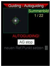
Wird das Autoguiding gestartet, erscheint der rote Schriftzug AUTOGUIDING blinkend unter dem Bild, und ein rotes Fadenkreuz markiert den Punkt an dem der Stern aktuell gehalten wird.
