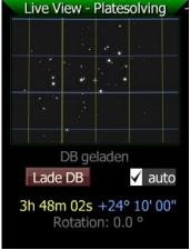
Nach dem Laden wird jedes Bild analysiert, und auf allen Bildschirmen welche das live Bild anzeigen erscheint das Koordinatennetz und die Koordinaten des Mittelpunkts (kleines Kreuz).
