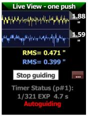
Der Mgen-3 beginnt mit der **Sternsuche**, identifiziert und wählt mehrere geeignete Sterne aus, führt danach die **Kalibration** mit der Montierung (welche bereits nachführen muss!) durch, und startet dann automatisch das **Autoguiding.** Der Timer Status wird hier auch angezeigt.
