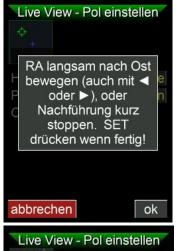
Dazu wird die RA Achse langsam ein kleines Stück Richtung Osten bewegt, das kurze Stoppen der Nachführung hat denselben Effekt. Die Bewegung kann hier auch über die **Pfeiltasten** des Mgen3 ausgeführt werden, drücken Sie zB 8 Sekunden lang die **LINKS** Taste. Mit SET bzw. ok bestätigen wenn die Bewegung ausgeführt ist.
