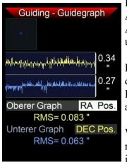
In der Voreinstellung werden die **Positionen** des Multisternes in beiden Achsen zur Null Linie angezeigt. Die RA Achse ist die obere, die DEC Achse die untere Kurve. Der Guidegraph wird bei jedem Guide Zyklus upgedated. Es werden ca. die letzten 220 Positionen angezeigt.
