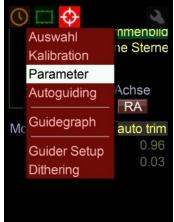
Hier können einige für das Funktionieren des Guidings wichtige Werte eingestellt werden. Die voreingestellten Werte sind so konfiguriert, dass sie mit nahezu allen denkbaren Situationen zu guten Ergebnissen führen. Der Mgen-3 bietet aber auch die Möglichkeit der vollen manuellen Kontrolle, hier können der Algorithmus und Effektivität beeinflusst werden.
