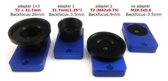
Die Kameraeinheit ist extrem leicht gebaut und wiegt nur etwa 40 Gramm. Der Anschluss an das Guidescope erfolgt über ein T2-Gewinde, eine 31.7mm Steckhülse oder durch das M28,5 Filtergewinde. Bei Verwendung des T2 Gewindes ist Mgen-3 mit MGEN-2 kompatibel (Backfocus: 9 mm)
