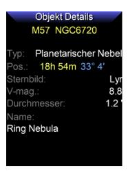
Im oberen Bereich werden alle Katalog-IDs für dasselbe Objekt angezeigt. Typ, Position (RA, DEC), Sternbild, Durchmesser ist selbsterklärend, V-mag ist die ungefähre visuelle Helligkeit des Objekts. Auch die (englischen) Eigennamen sind aufgeführt, falls es welche gibt.
