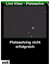
Bemerkung: Während Sie das Guidescope bewegen, laufen die Belichtungen ständig weiter und die Sterne werden verschmiert. Diese Anzeige sagt Ihnen, dass das aktuelle Bild nicht astrometriert werden konnte. Warten Sie einfach eine Sekunde, bis das nächste Bild kommt und verarbeitet wird. Diese Meldung erscheint auch, wenn das Guidescope nicht auf den Bereich gerichtet ist, der von den Sterndaten abgedeckt wird.
