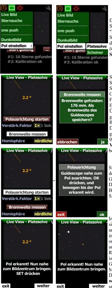
Der entsprechende Bildschirm ist mit der Scheiner-Methode gruppiert im Menü "Imaging", Untermenü "Polar alignment". Setzen Sie den Cursor auf Polar align und drücken Sie SET, um das Untermenü zu öffnen. Drücken Sie zum Aufrufen erneut SET.
