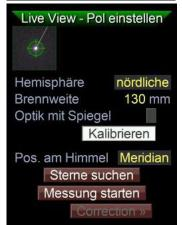
Der Mgen3 zeichnet danach eine kleine Linie vom Multistern weggehend, welche in Richtung des sichtbaren Poles zeigt. Der Mgen3 kennt nun die Ausrichtung der Montierungsachsen zur Kamera.
