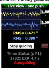
Das Live Bild wechselt zum Guidegraphen, rechts wird die Skalierung der Y Achse und darunter die Standardabweichung rms angezeigt. Hier kann auch das Guiding gestoppt und wieder fortgesetzt werden. Wird das Teleskop zu einem neuen Feld geschwenkt, erfolgt vor dem Fortsetzen automatisch eine neue Sternsuche und Kalibration. Bei Bedarf kann die Kalibration durch eine vorhergehende manuelle Sternsuche von hier aus getriggert werden.
